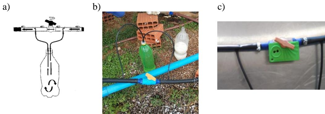
**Figura 11.** a) esquema funcionamento do Fertipet; b) Fertipet conectado a linha de irrigação; c) gabarito calibrador de registro de esfera. **Fonte:** imagens autor
