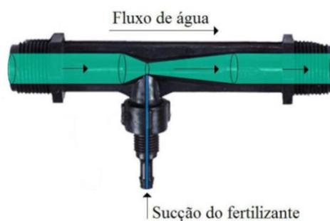
**Figura 1.** Esquema de funcionamento do injetor Venturi. Fonte: adaptado de Biscaro (2014).
